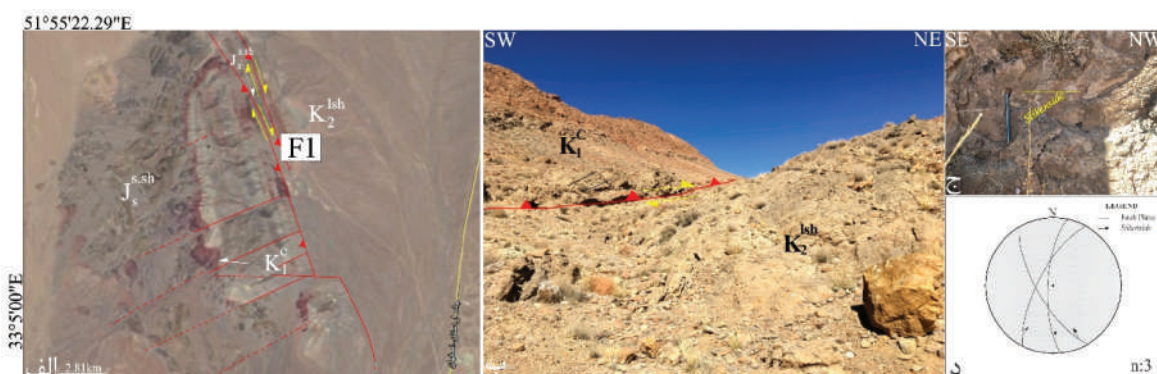
شکل ۴. الف) تصویر ماهواره‌ای Google earth از موقعیت گسل F1، ب) پهنه گسلی F1 که در امتداد آن واحدهای ژوراسیک و کرتاسه زیرین مجاورت واحدهای کرتاسه بالایی قرار گرفت، ج) نمایی از موقعیت خشلغز و صفحه گسلی، د) نمایش تحلیل کینماتیکی با توجه به برداشت‌های میدانی روی استریونت که نشانگر موقعیت سطح گسل F1، با سازوکار راستالغز راست‌بر با مؤلفه شییبی معکوس است
