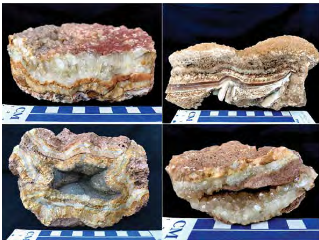
شکل ۳. تعدادی از نمونه‌های برداشت شده از نهشته‌های تراورتن در سطح با ساختار لایه‌ای، دروزی و نواری متحدالمرکز
