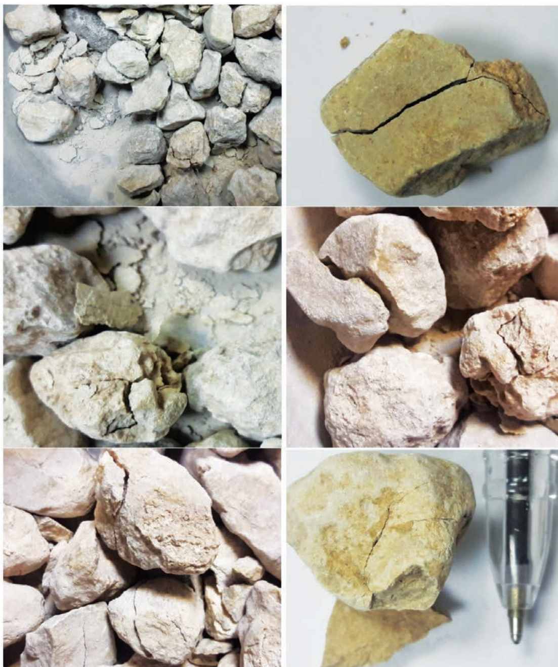
شکل ۷. نمونه‌هایی از تخریب سنگ‌دانه‌ها به علت سیکل‌های یخ‌زدگی-آب‌شدگی
