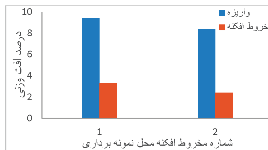
شکل ۱۵. اختلاف بین میزان افت وزنی ناشی از ۱۰ سیکل یخزدگی-آبشستگی سنگدانه‌های تجمع یافته در مخروط‌افکنه‌ها و واریزه‌های واقع در حوضه بالادست آن (۱۲/۵-۹/۵ mm)
