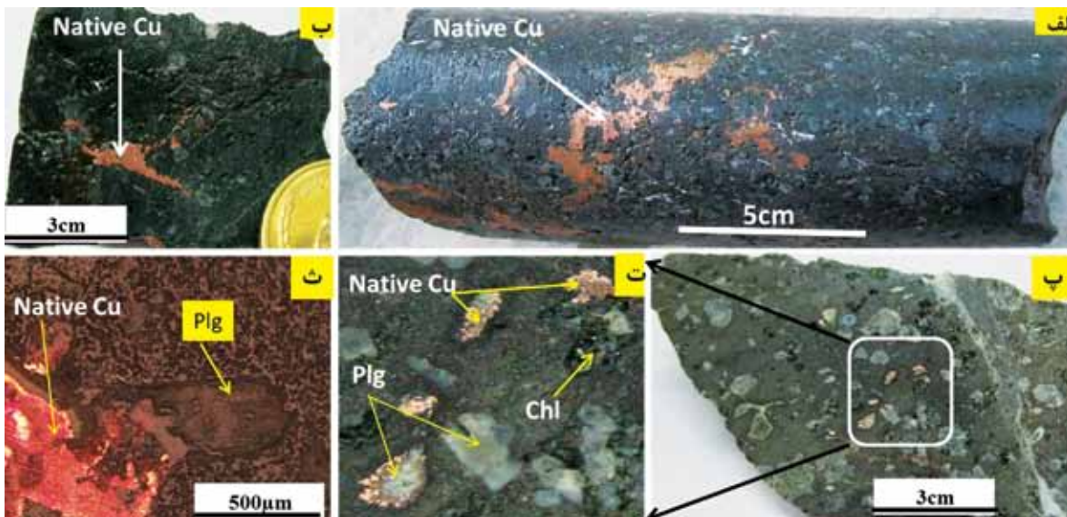
شکل ۵. کانه‌زایی مس طبیعی در سنگ میزبان آندزی بازالت دگرسان شده کانسار گرماب پایین. الف و ب) نمونه دستی از بافت رگه-رگچه‌ای مس طبیعی، پ و ت) نمونه دستی از بافت دانه پراکنده کانه‌زایی مس طبیعی، ث) تصویر میکروسکوپی از مس طبیعی (نور انعکاسی PPL). کلریت (Chl) و پلاژیوکلاز (Plg)
