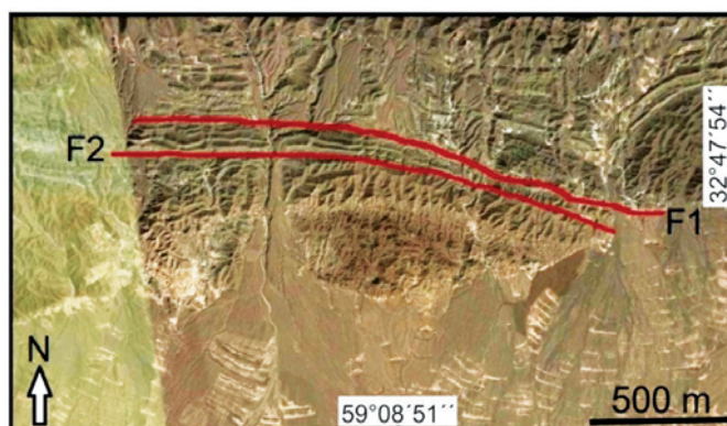
شکل ۱۱. تصویر هوایی از خطواره گسل F2 که قابل مقایسه با دومین راندگی تشکیل شده در مدل سازی با اعمال ۲۷/۵ درصد کوتاه شدگی است
