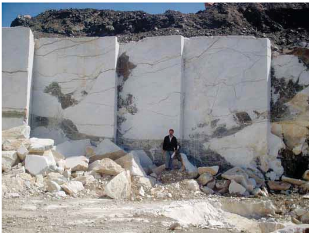
شکل ۹. توسعه شکستگی و گسل خوردگی در معادن شمال غرب منطقه
