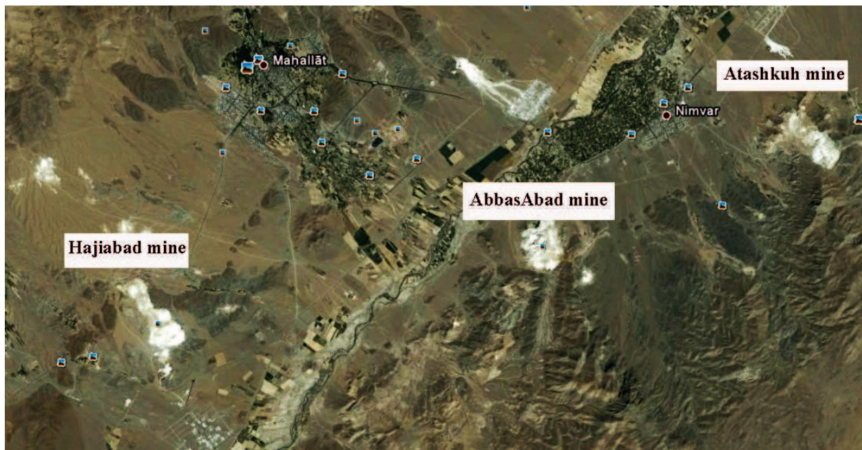
شکل ۱. عکس ماهواره‌ای منطقه محلات. بخش‌های روشن‌تر نشان دهنده معادن کوچک و بزرگ تراورتن است. در این شکل جایگاه معادن حاجی‌آباد و عباس‌آباد نیز مشخص شده است.
