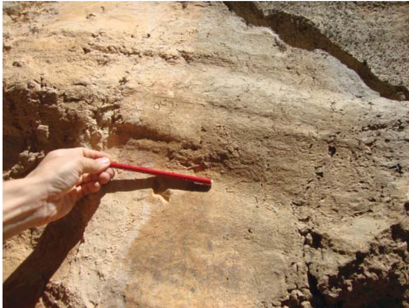
شکل ۴. گسل امتدادلغز موجود در محدوده مورد مطالعه (جهت دید ناظر به سمت شمال باختر).
