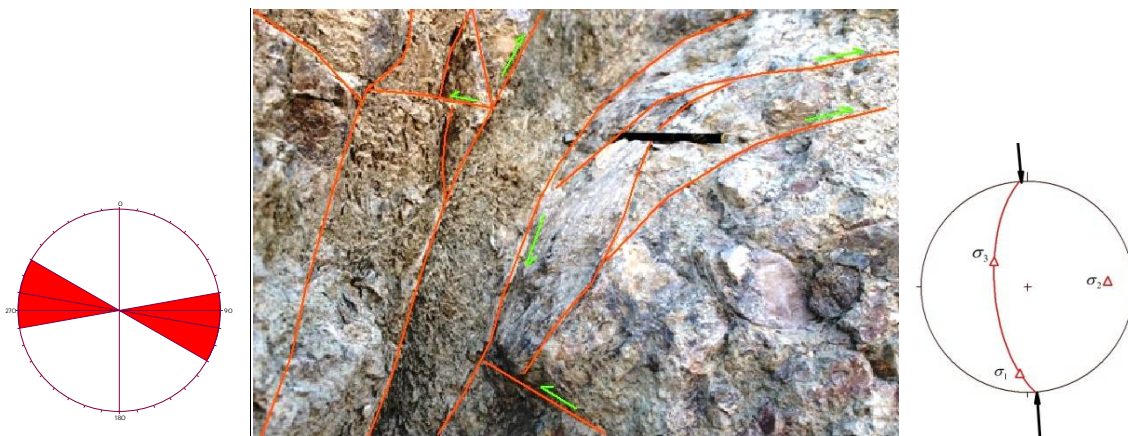
شکل 4. سطوح گسل‌های راندگی و معکوس بزرگ زاویه عمود بر هم به همراه نمودار گل سرخی و استریوگرام آن (دید به سمت جنوب)
