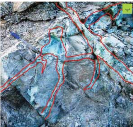
شکل ۴. الف) نمونه دستی از واحد تراکی آندزیت مگاپورفیری میزبان کانه‌زایی مس، ب) کانه‌زایی رگه - رگچه‌ای محدود به واحد مذکور
