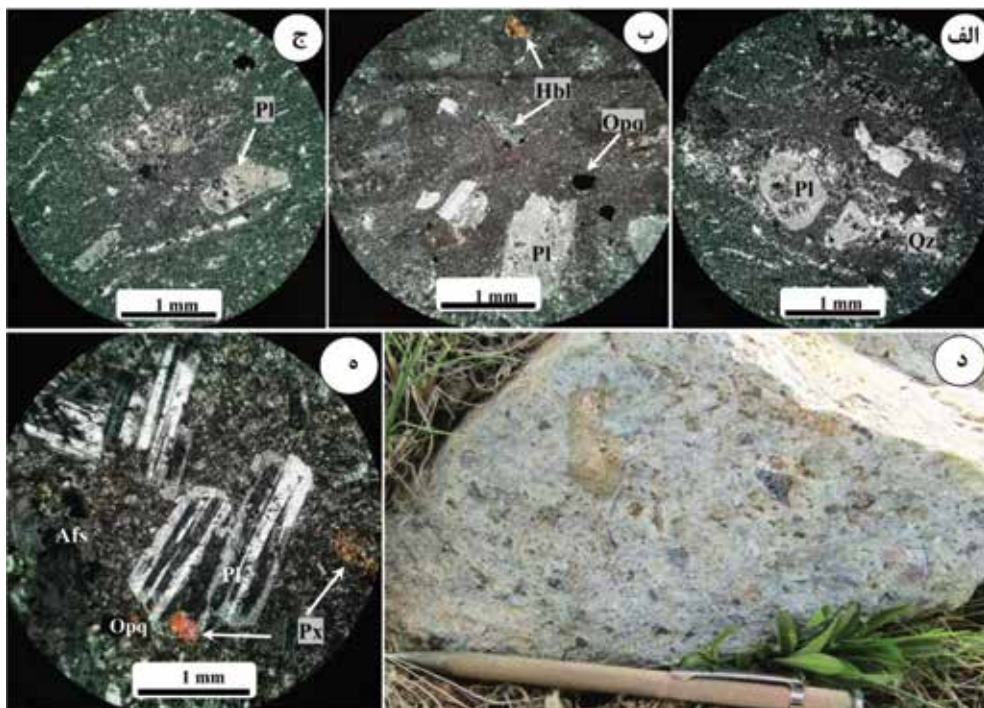
شکل ۳. الف) تصویر میکروسکوپی از سنگ‌های ویتریک‌توف در همراهی با واحد E^1 ، ب و ج) تصاویر میکروسکوپی از واحد گدازه آندزیت و تراکی‌آندزیتی ( E^{an} )، د) تصویر واحد لیتیک‌توف ( E^2 )، ه) تصویر میکروسکوپی از توده مونزودیوریتی (md) در محدوده غرب گلستان‌آباد. تصاویر میکروسکوپی در نور عبوری با نیکول‌های متقاطع (XPL) برداشت شدند. Afs: آلکالی‌فلدسپار، Hbl: هورنبلند، Opq: کانی کدر، Pl: پلاژیوکلاز، Px: پیروکسن. نشانه‌های اختصاری کانی‌ها از ویتنی و اوانز (Whitney and Evans, 2010) اقتباس شده‌اند
