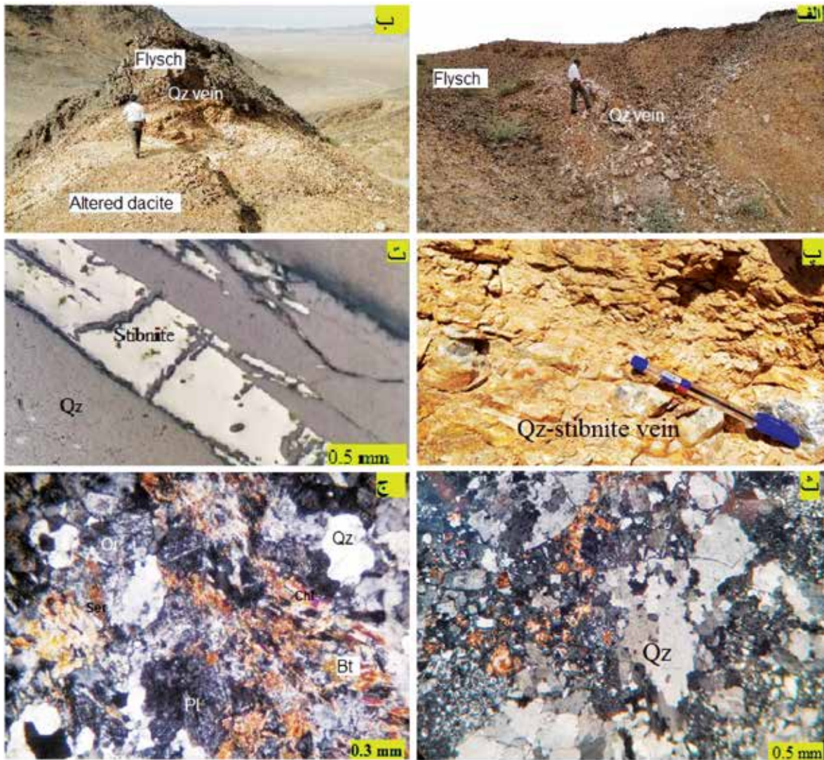
شکل ۷. عکس‌های صحرایی و میکروسکوپی از منطقه لخشک، الف) رگه‌های کوارتز (Qz) بدون کانی‌زایی، دید به سمت شمال، ب) رگه‌های کوارتز-استینیت دارای هاله دگرسانی، دید به سمت شمال، پ) نمایی نزدیک از رگه‌های کوارتز-استینیت، ت) بلورهای تیغه‌ای استینیت در زمینه‌ای از بلورهای کوارتز در نور منعکس شده، ث) بلورهای ریز و درشت کوارتز در رگه سیلیسی در نور پلاریزه متقاطع، ج) بلورهای کوارتز، بیوتیت (Bt)، سربیسیت (Ser)، کلریت (Chl)، پلاژیوکلاز (Pl) و ارتوکلاز (Or) در هاله دگرسانی در نور پلاریزه متقاطع، نشانه‌های اختصاری از Whitney and Evans (2010)
