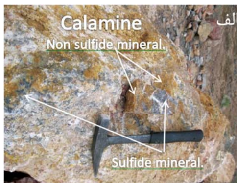
شکل ۴. الف) آهک دولومیتی شده به همراه کانه‌زایی روی و سرب سولفیدی و غیرسولفیدی؛ ب) لایه سولفیدی اکسید شده ناشی از دگرسانی گرمایی در سنگ آهک دولومیتی شده
